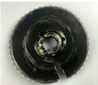
图 2 中央从动锥齿轮幅板裂纹形状 Fig. 2 Fatigue crack of the disk of central driven bevel gear
